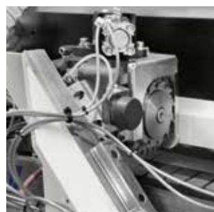
Groupe de coupe en bout K-2 Radius Coupe et arrondissement en une seule opération.
