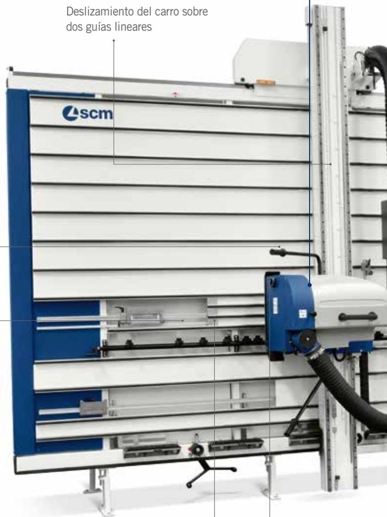
Deslizamiento del carro sobre dos guías lineares
